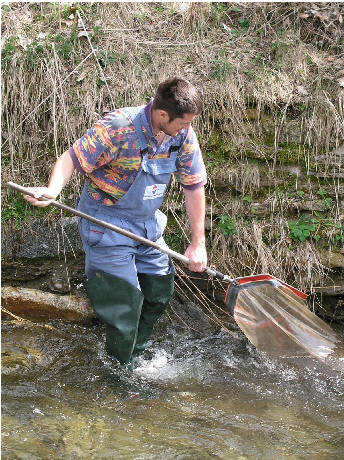
Obr. 1 Odběr vzorku makrozoobentosu za použití ruční sítě
