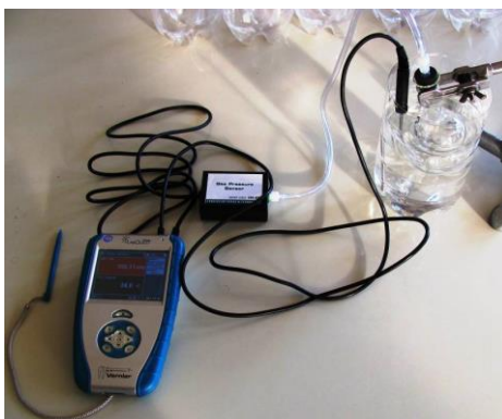
Obr. 3 Aparatura k ověření izochorického děje (podle www.vernier.cz )
