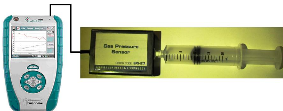
Obr. 1 Aparatura na ověření izotermického děje (podle www.vernier.cz )
